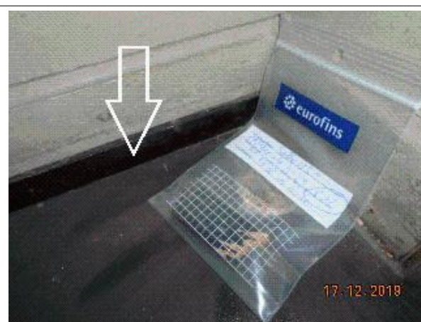
Prélèvement - P12 : TI MULHOUSE / R+1 / SALLE 115 - Peinture- (Absence d'amiante)
