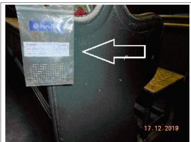
Prélèvement - P11 : TI MULHOUSE / R+1 / SALLE 115 - Peinture- (Absence d'amiante)
