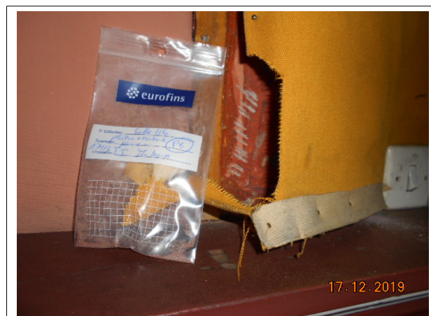
Prélèvement - P6 : TI MULHOUSE / R+1 / SALLE 114 - Revêtement- (Absence d'amiante)
