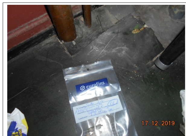
Prélèvement - P2 : TI MULHOUSE / R+1 / SALLE 114 - Lé plastique avec sous-couche- (Absence d'amiante)
