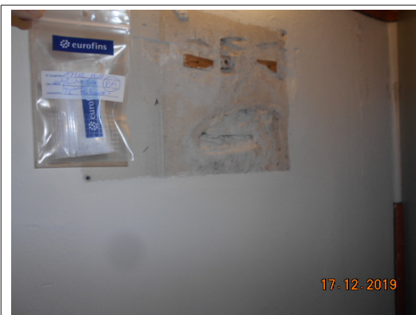
Prélèvement - P14 : TI MULHOUSE / RDC / ENTREE - Enduit- (Absence d'amiante)
