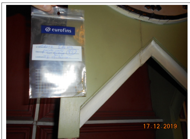
Prélèvement - P5 : TI MULHOUSE / R+1 / SALLE 114 - Peinture- (Présence d'amiante)
