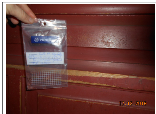
Prélèvement - P4 : TI MULHOUSE / R+1 / SALLE 114 - Peinture- (Absence d'amiante)
