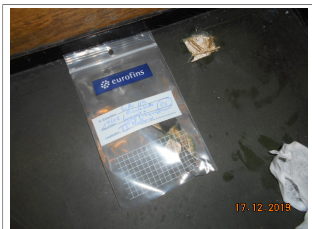
Prélèvement - P1 : TI MULHOUSE / R+1 / SALLE 114 - Lé plastique avec sous-couche- (Absence d'amiante)
