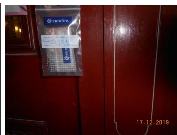
Prélèvement - P16 : TI MULHOUSE / RDC / ENTREE - Peinture- (Absence d'amiante)
