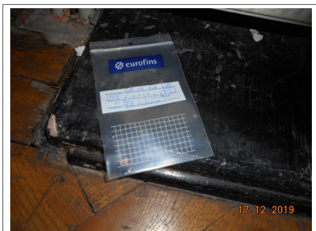
Prélèvement - P3 : TI MULHOUSE / R+1 / SALLE 114 - Enduit bitumineux- (Absence d'amiante)
