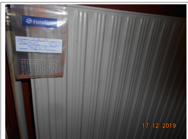
Prélèvement - P7 : TI MULHOUSE / R+1 / SALLE 114 - Peinture- (Absence d'amiante)
